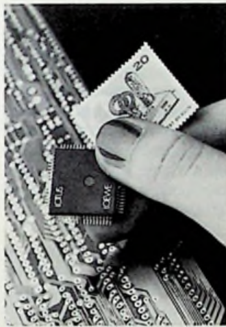
Bild 1: Lotus heißt ein selbstentwickelter VLSI-Baustein für Btx-Decoder (Loewe-Pressbild)
