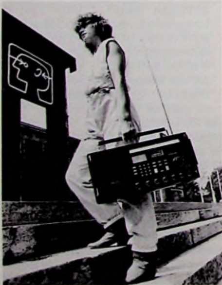
Bild 3: Der „große“ Satellit 600 hat die Abmessungen eines Bordcase und mit mehr als 9 kg auch dessen Gewicht
