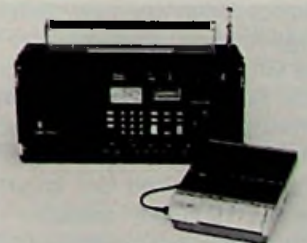
Bild 1: Schaltuhr des Satellit 600 steuert Cassettenrecorder (Grundig-Pressbild)
