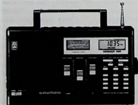
Bild 1: Vom Aussehen und Gewicht her ähnelt der Satellit 300 eher einer Handtasche, ist aber ein leistungsfähiger Reiseempfänger, der auch Laien den Kurzwellenempfang leicht macht
